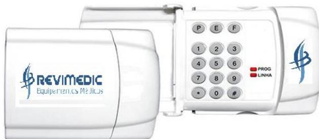
O tele alarme funciona através de uma linha telefônica. Faz ligações para os números registrados quando a temperatura sair faixa programada, ou se a tensão da bateria estiver baixa. Para que o discador funcione, é necessário conectar um cabo telefônico.
